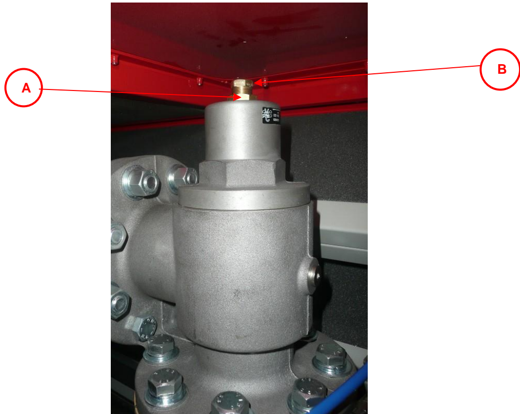
Figure 11.3-1 Réglage de la pression minimale du circuit pneumatique
